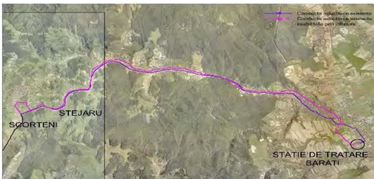
Figura 6 Opțiunile analizate privind reabilitarea conductei de aducțiune apă brută de la Scorteni la stația de tratare Barați
