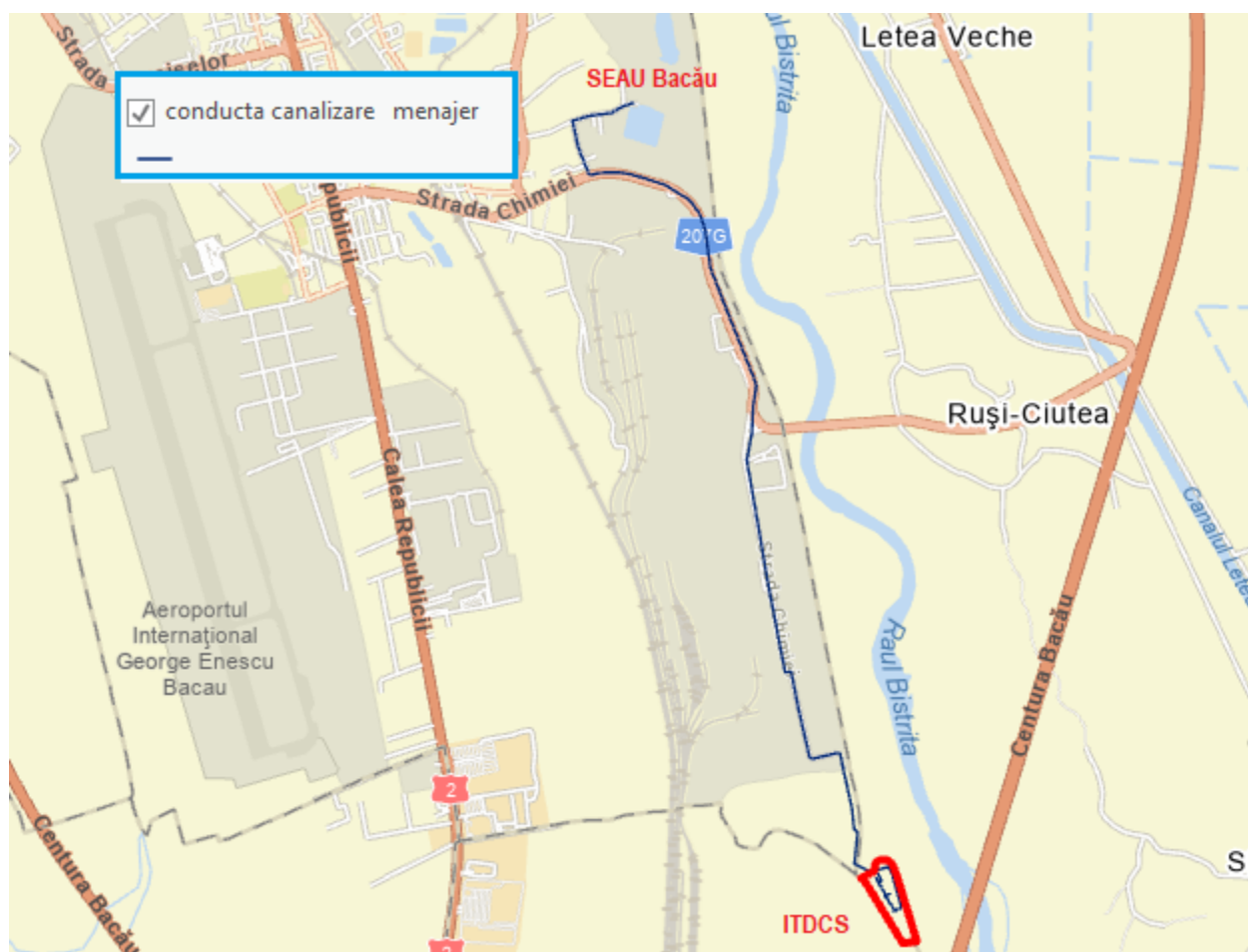
Figura 13. Traseul conductei de apă uzată propusă de la limita de proprietate a obiectivului până la punctul de racordare
