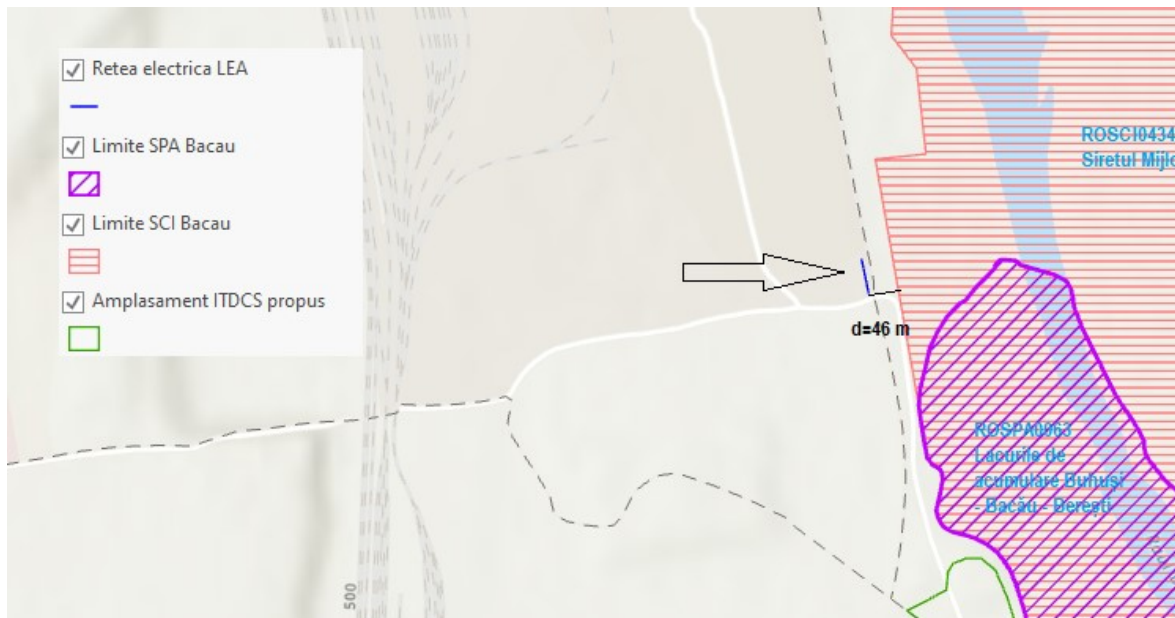
Figura 17. Modalitatea de conectare la rețeaua electrică
